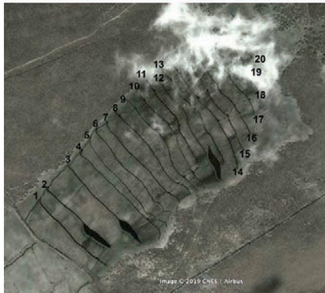
Figura 2. Detalle de los canales que drenaban la turbera de Chakana. a) Canales longitudinales abiertos en una fecha indeterminada, posiblemente antes de principios del siglo XX. b) Canales transversales abiertos alrededor del año 2014 como parte de un experimento piloto para crear hábitat para aves acuáticas migratorias.
